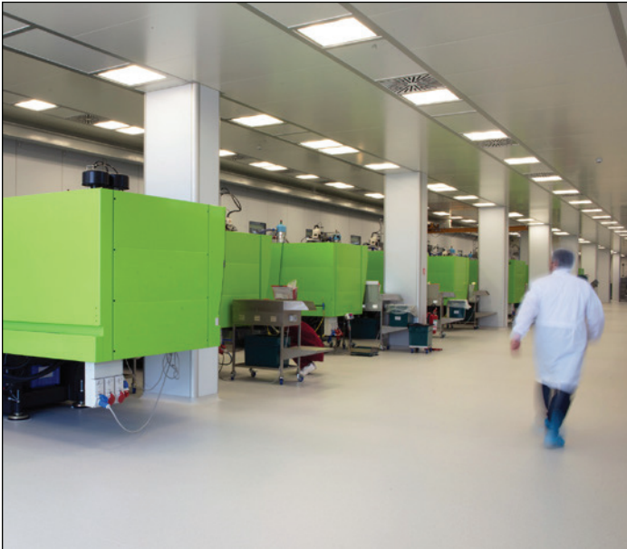
Abbildung 4. Reinraum-Spritzguss biomedizinischer Produkte – eine übliche Anlage bei Herstellern von Medizinprodukten. Bild mit freundlicher Genehmigung Dreamstime (ID 48273907) © Moreno Soppelsa.
