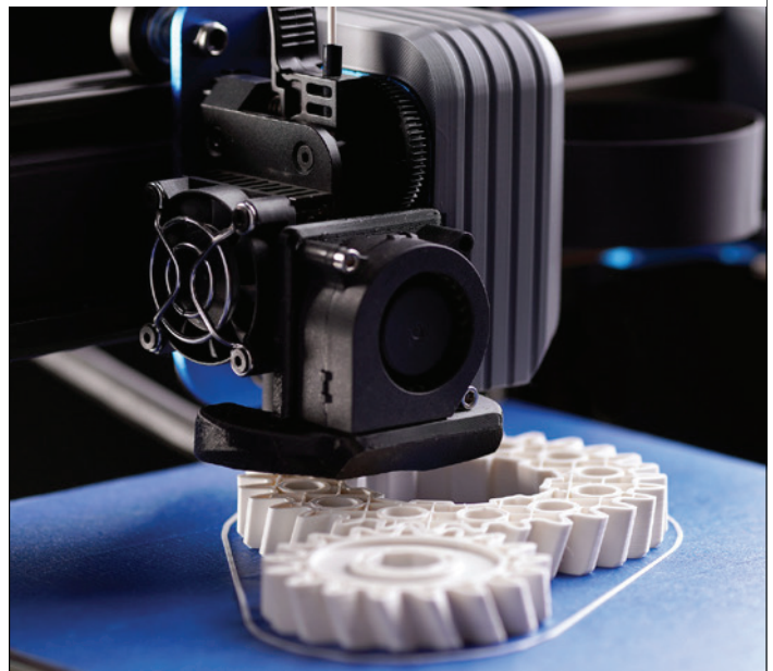
Abbildung 5. Die FDA hat kürzlich einen Leitfaden zu technischen Überlegungen für additiv gefertigte Medizinprodukte veröffentlicht. 13 Hier das Portal mit X-Schlitten und Druckkopf eines Schmelzschichtung-3D-Druckers (Fused Deposition Modeling FDM), der weiße Schrägverzahnungen herstellt. Bild mit freundlicher Genehmigung Dreamstime (ID 241350887) © Roman Boettcher.
